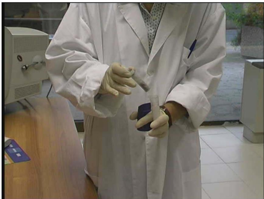
**Figura 12. Inserimento del filtro con la polvere nell'apposita custodia**
