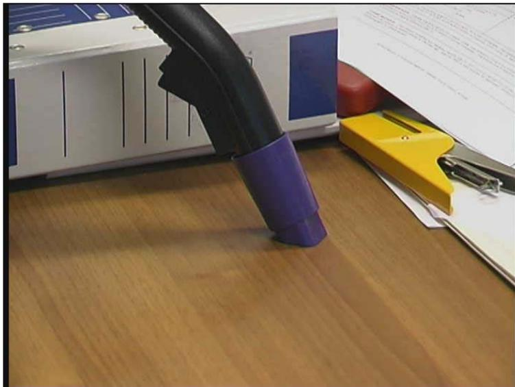
**Figura 5. Posizionamento del beccuccio durante l'aspirazione**
