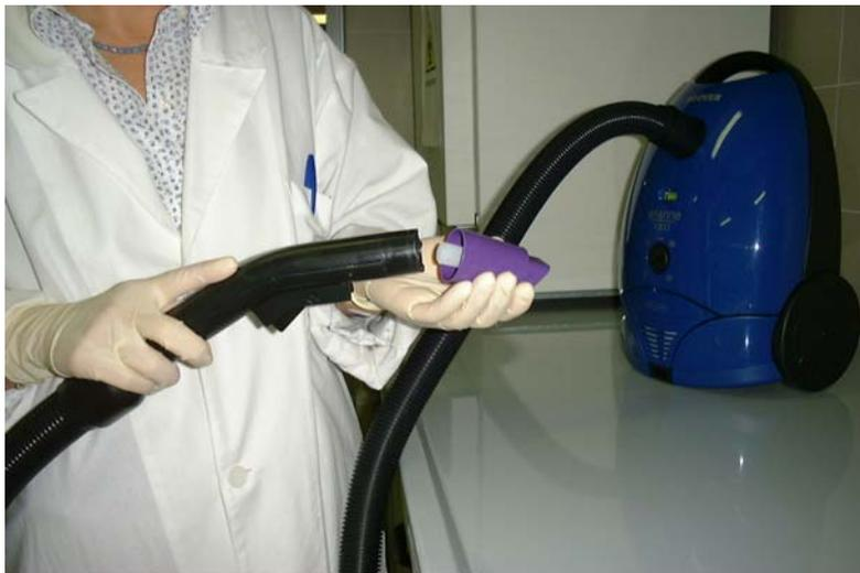
**Figura 4. Inserimento dei beccucci adattatori nel tubo dell'aspirapolvere**
